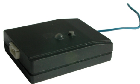
1 pav. GSM signalo slopinimo jutiklis 'D-JAM'.
