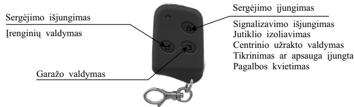
3 pav. Trijų mygtukų siūstuvėlis.
