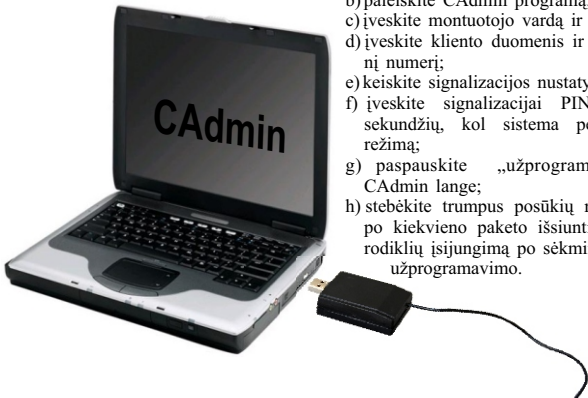
1 pav. Įranga kompiuterizuotam sergėjimo sistemos nustatymų programavimui.
